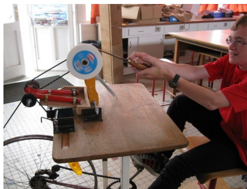
Pédalier multi-fonction (machine à coudre et meule)
