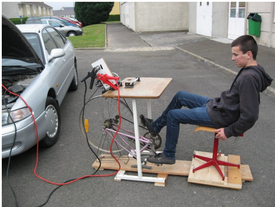
Pédalier multi-fonctions (recharge batterie de voiture)
