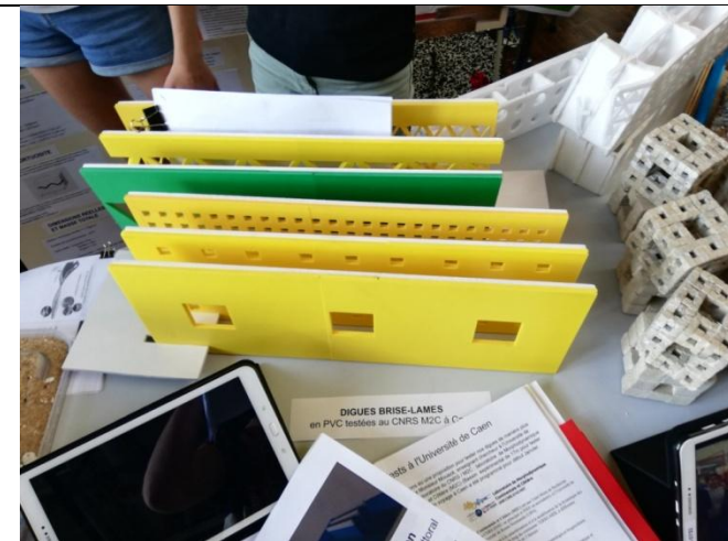
Les élèves ont réalisé plusieurs tests afin de trouver le modèle de digues le plus résistant aux vagues. Différentes formes, différents matériaux ont été testés dans des bassins à vagues.
