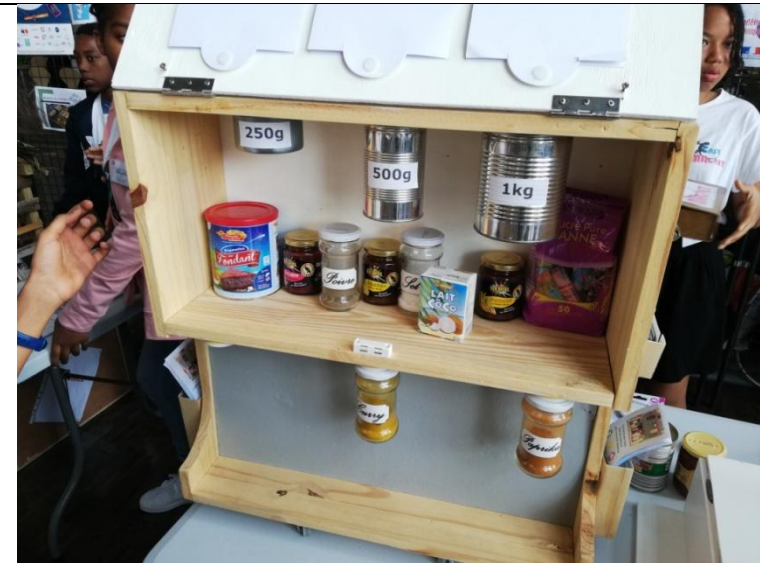
Construction, production et mise en vente d'un support aimanté permettant de suspendre des boîtes de conserve dans un placard pour gain de place. Ce support est construit à l'aide d'aimant recyclé à partir d'anciens disques durs.
