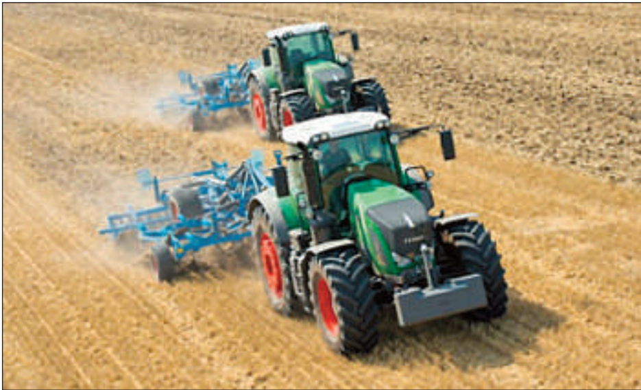
Deux tracteurs connectés en maître-esclave.
