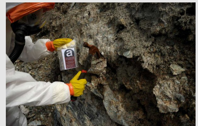
Prélèvement d'échantillons dans une ancienne carrière d'amiante
