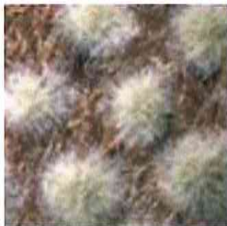
Développement de moisissures grandissement x50
