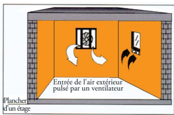
Ventilation par air pulsé
